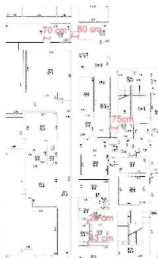
Ilustrācija Nr. 4 – pagrabstāva izmērītie sienu biezumi ar apdari.
