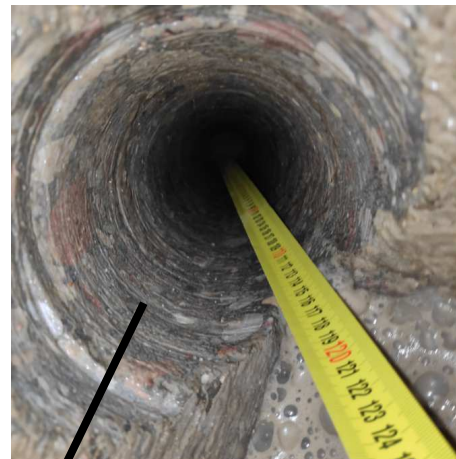
Betona cilindru d100x170mm urbšana režģogos spiedes testiem RTU Būvmateriālu laboratorijā
