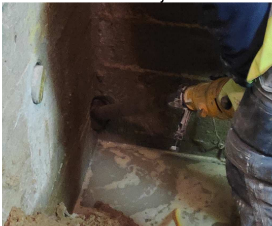
Betona cilindru d100x170mm urbšana režģogos spiedes testiem RTU Būvmateriālu laboratorijā
