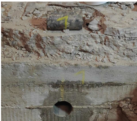
Betona cilindru d100x170mm urbšana režģogos spiedes testiem RTU Būvmateriālu laboratorijā
