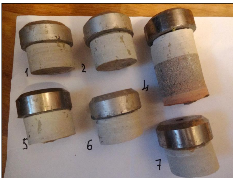
Testa rezultāti — no ārsienu pamatstruktūras atrautie paraugi (metāla diski kopā ar t.sk. pielīmētajiem caururbto dolomīta apdares plākšņu fragmentiem)
