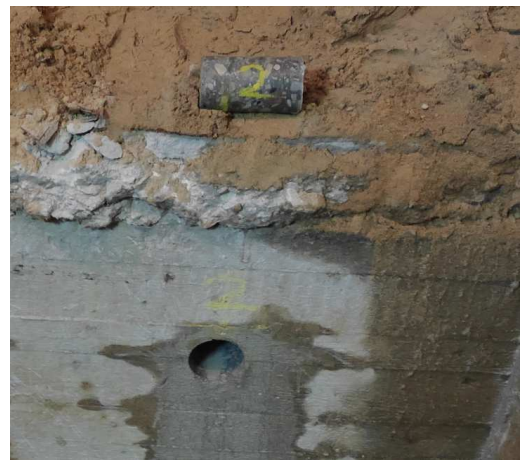
Betona cilindru d100x170mm urbšana režģogos spiedes testiem RTU Būvmateriālu laboratorijā
